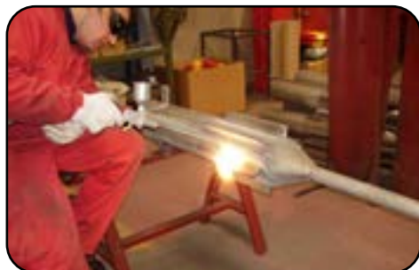
Наплавка износостойкого слоя с помощью горелки SuperJet-S
