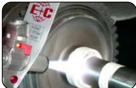
Восстановление посадочного места вала порошком на основе никеля RotoTec® 19940
