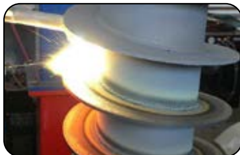
Нанесение износостойкого покрытия с помощью насадки SF Lance
